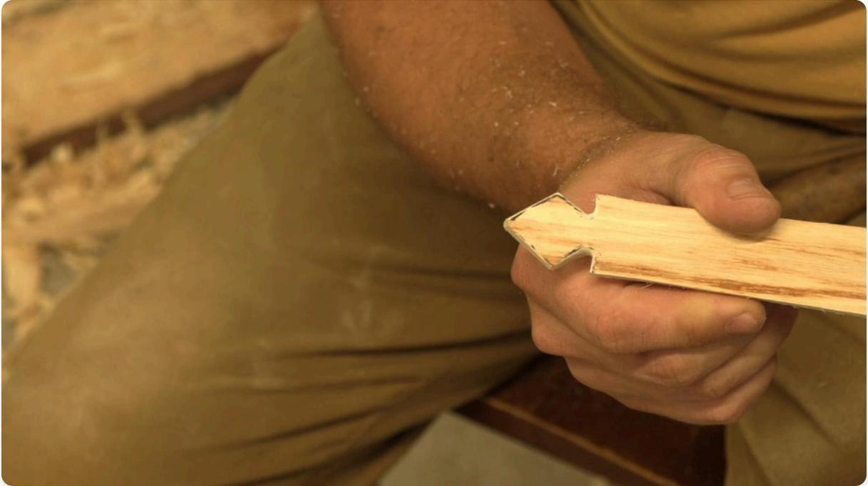
小心地用刀子削出形状。你可以用刀子、锉刀或砂纸稍微清理一下边缘。
