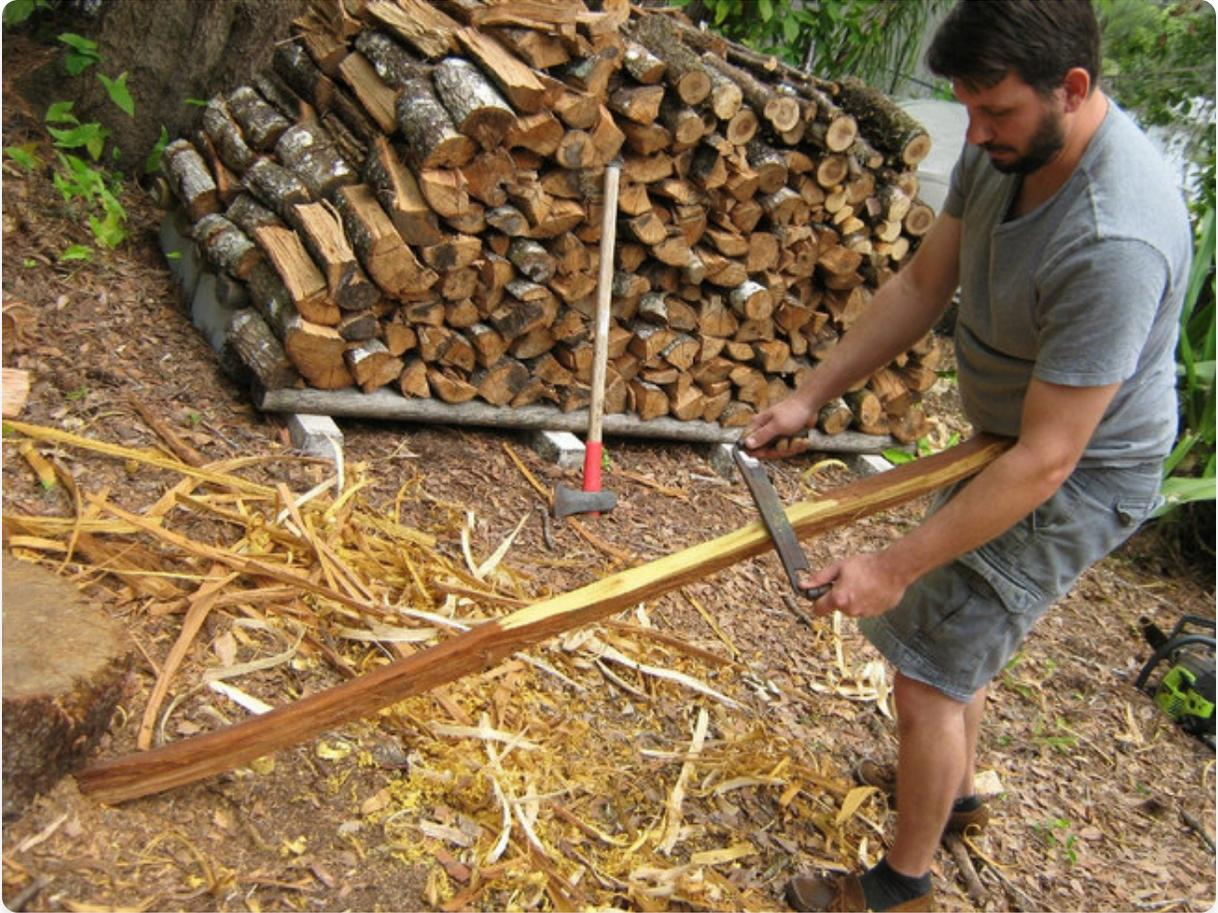
好的锋利工具应该相对容易地去除木材，你永远不应该在拉拔刀回到你身边时费力。另外，由于拔刀是平的，它不像将尖刀向自己方向工作那样危险。无论如何，请小心。你越接近身体追逐年轮，你的触觉可能会越轻！我还建议在你的身体和木条之间放一个好的皮垫。这将防止木条割伤你，也会在刀片和你的身体之间提供一些安全保障。如果你讨厌这种技术并想使用夹具，那么请务必这样做。你也可以用2个木工夹将木条夹在桌子上来固定弓。最重要的是，找到对你感觉舒适和安全的方法。
