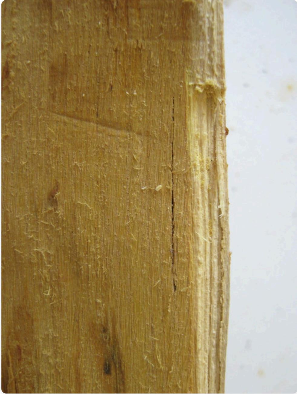
劈裂之后是削减。在弓材准备好储存进行风干之前，必须对弓材进行一些削减。桑橘(Osage)弓材的最大问题之一是需要去除树皮和边材。99%的情况下，我们使用心材（内部深色木材）来制作弓。像山核桃、山茱萸或榆木这样的木材，我们使用边材（白色木材）作为弓的背面，但其他木材如桑橘和刺槐，我们使用心材，因为它能制作更好的弓。许多人跳过树皮和边材去除阶段，选择让它带着这些部分风干。虽然这在前面提到的那些白木上实际上可以做到，但这经常在桑橘中造成层状裂缝。层状裂缝实际上是生长环之间的分层。许多人不寻找这些，经常导致被误诊的弓失效。我不确定确切的原因，但我向你保证，几乎所有带着边材风干的弓材都会遭受
