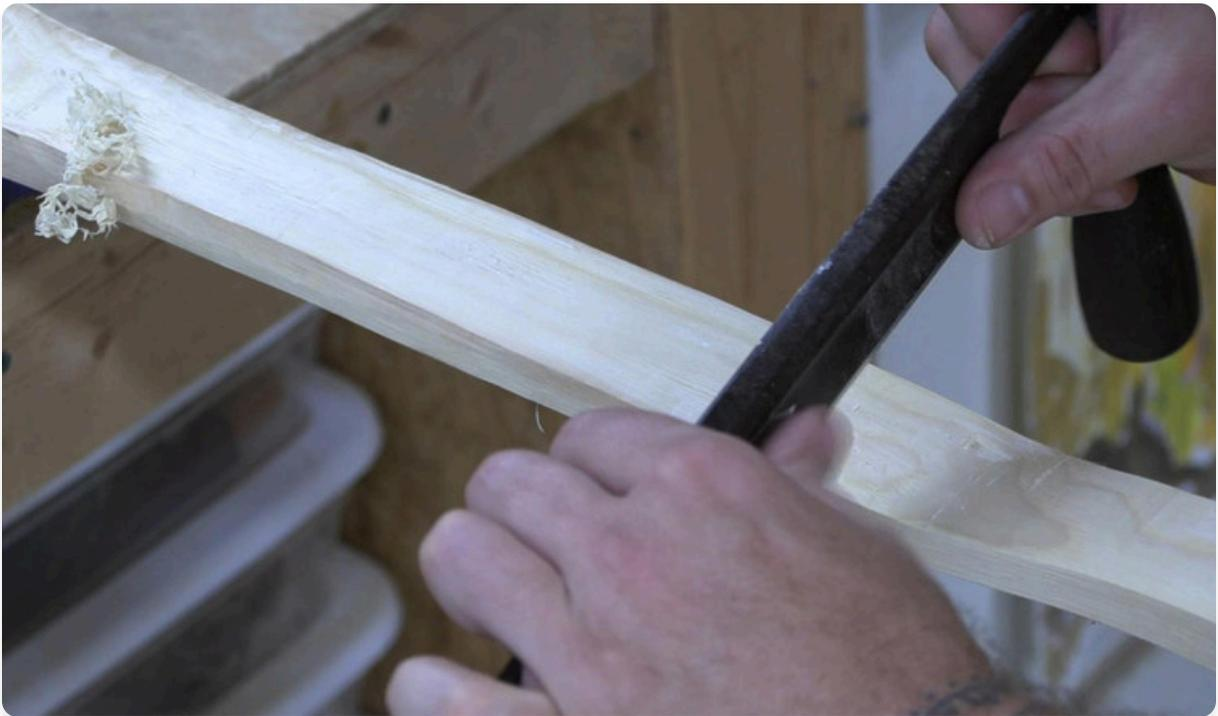
我使用拉刀作为刮刀进行更精细的木材移除和调整。注意我握住刀片而不是握柄。刀片保持约90度角，小刨花被推离。注意照片左侧更精细的木卷。我向身体方向拉刀，但通过推离来刮削。
