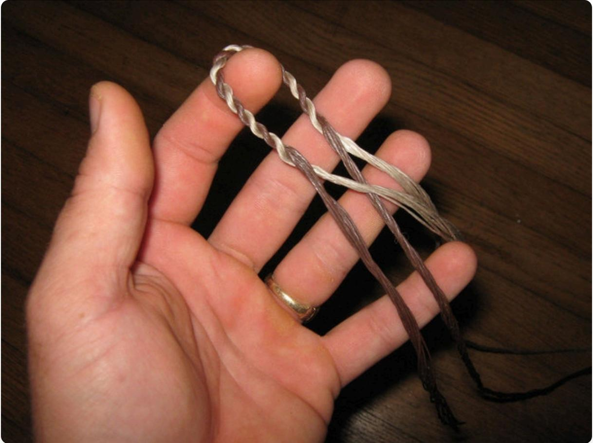
折叠绳索形成一个环。将7英寸的猪尾巴放在长束的顶部，然后以紧绳的方式将它们拧在一起。这样就形成了一个顶部环。
