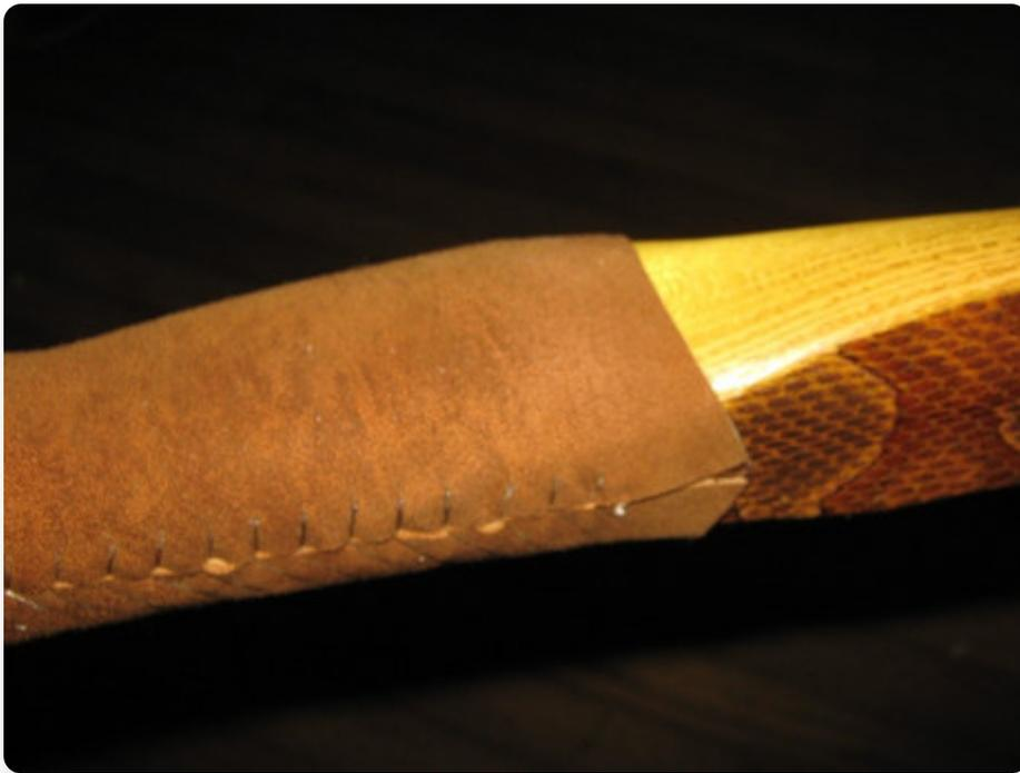
用锋利的刀子勇敢地切一刀，在底部修剪皮革。添加一点形状，这样看起来不会无聊。任何松散的皮革瓣都可以用一滴强力胶粘下。
