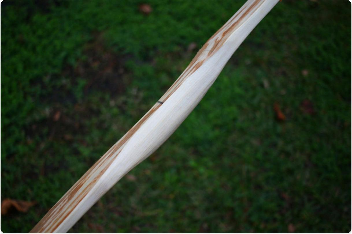
注意握把只有在渐变变厚时才开始逐渐变细。只有温和的渐变！只有在不弯曲的较厚渐变上，你才能开始削薄握把的背面轮廓。如果你切入任何工作臂，你会在张力下创建一个薄弱点。砰！瞬间变成牙签！
