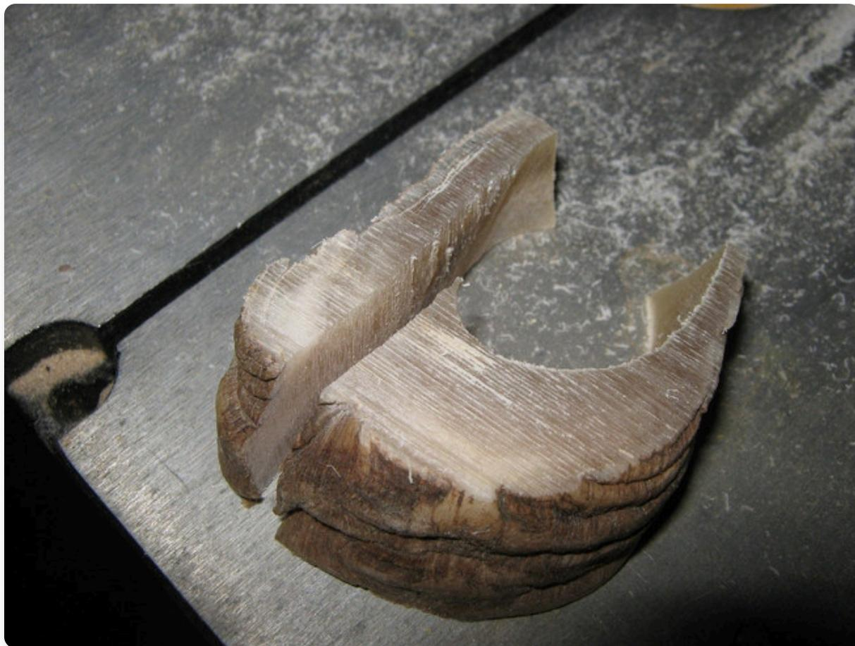
切了一片后，我们可以在带锯上修整以获得我们想要的部件。我切了2片相同的切片，并在每个覆盖层上使用相同的平面。
