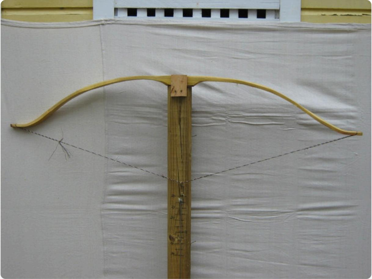
在低支撑状态下缓慢调整到约18英寸后，我们可以看到左臂在内侧三分之一处有点僵硬，右臂在外侧三分之一处有点僵硬。
