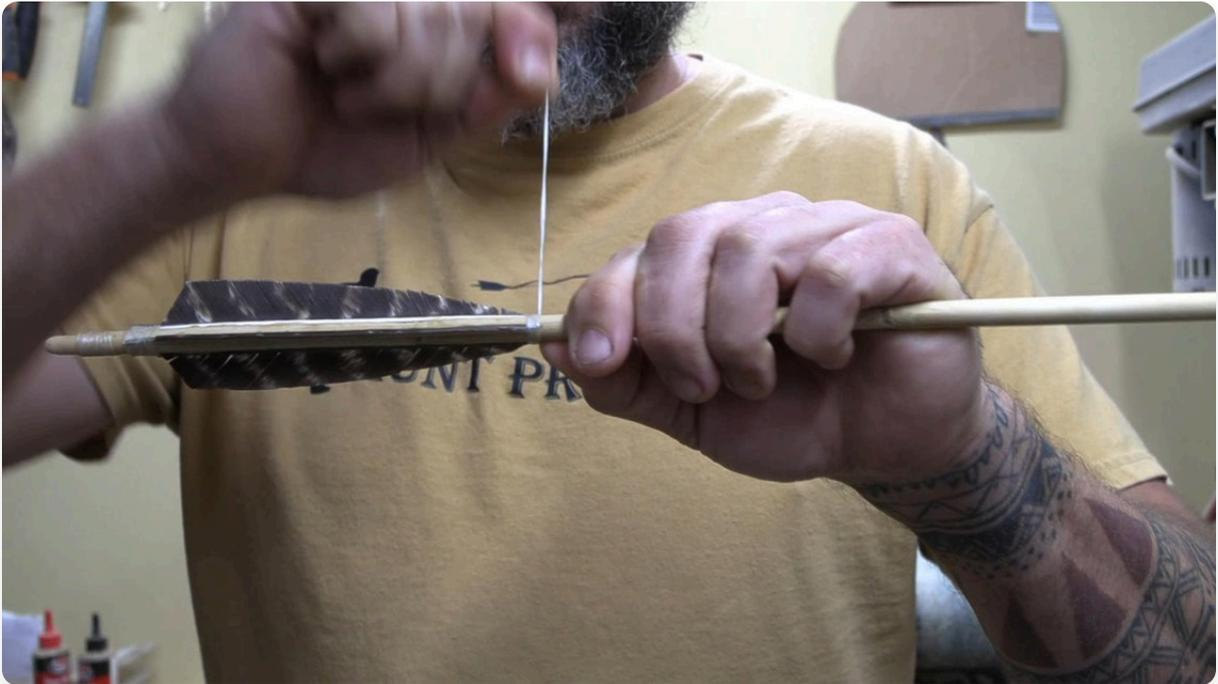
接下来，在羽毛的底端包裹韧带。在所有韧带包裹上涂一点木胶并让其干燥。不需要在羽毛之间螺旋包裹，因为羽毛现在已经粘在箭杆上了。一旦一切都干燥了，装羽工作就完成了。如果你愿意，可以在羽轴或韧带包裹上再涂一层胶水。
