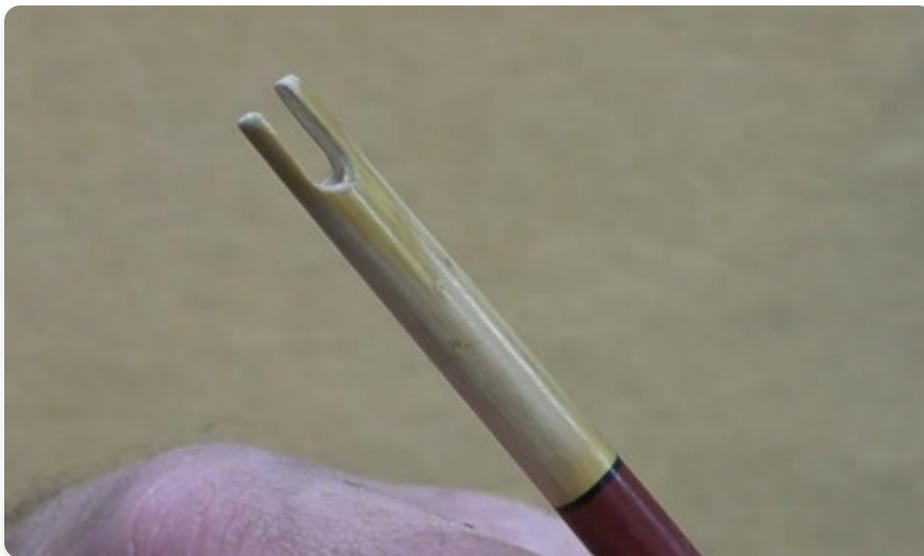
切削箭尾槽：切削箭尾槽很容易。我建议先切一个切口或缓解槽。你可以使用带锯、钢锯，或者像许多人做的那样，用2个钢锯片绑在一起。就此而言，你可以使用石片锯，就像我在一些视频中使用的的那样。无论哪种方式，在箭杆的细端切一个槽，大约3/8英寸深。不必精确。你可以根据需要切得深或浅。制作缓解槽后，我使用圆锉（链锯锉）将箭尾槽切到我想要的宽度。通常使用现代弦时，我使用1/8”锉。对于较厚的筋弓弦，我使用5/32链锯锉。如
