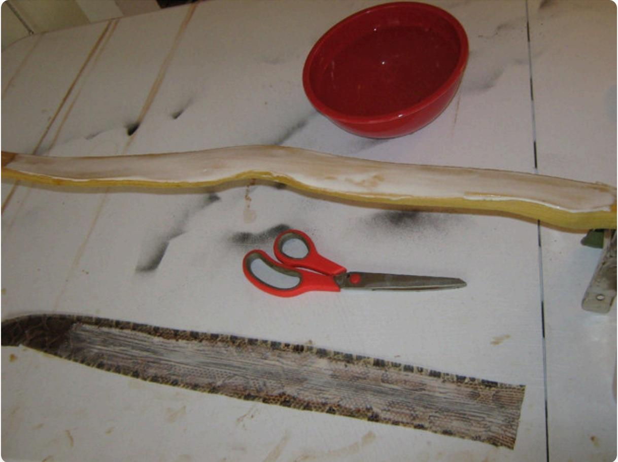
要将皮肤贴到你的弓上，轻轻打磨弓的表面。避免任何脱模剂，如蜡、油或涂层。如果你的弓有涂层，你必须将其磨掉。如果你的弓有蜡或油，你需要用化学脱脂剂很好地清洁它。我特意避免蜡或油涂层就是出于这个原因。将皮肤添加到之前上油的弓上可能有风险。理想情况下，你希望在对弓施加任何涂层之前添加皮肤。为了打磨弓背，我轻轻使用80目砂纸。我不想移除木材或通过剧烈打磨破坏年轮。我只是想以圆周运动轻轻打磨，非常轻柔地划伤木材。这将有助于胶水粘合。如果木材是油性种类，你可能需要用异丙醇擦拭几次。将干燥的皮肤浸泡在冷水中约15-20分钟，直到非常软和柔韧。我喜欢用Dawn洗洁精彻底清洗我的皮肤以去除任何油脂。肥皂清洗后，用清水再次清洗。用纸巾轻轻拍干，并再次确保没有剩余的肉或脂肪。
