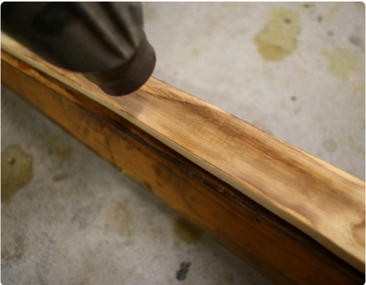
在中心夹紧后，每个弓臂都可以拉入模具并夹紧。这样做有可能会折断你的弓。通常山核桃足够坚固，不会折断。此外，轻微的预热可以帮助”松动”弓臂使其向后弯曲。
