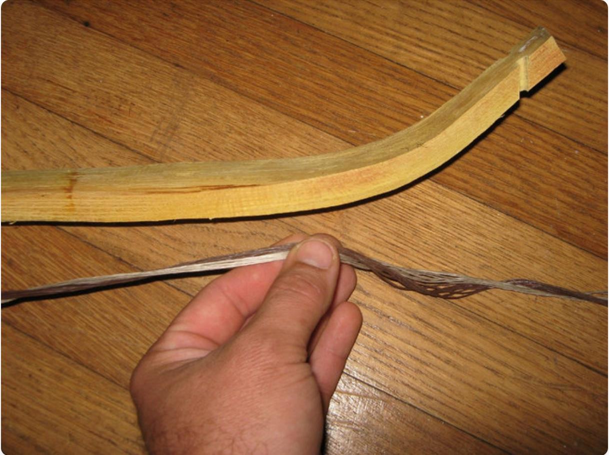
将第一个环再次放在顶部弓槽中，拉紧弦并在大约我手指捏住弦的位置开始紧密扭转。
