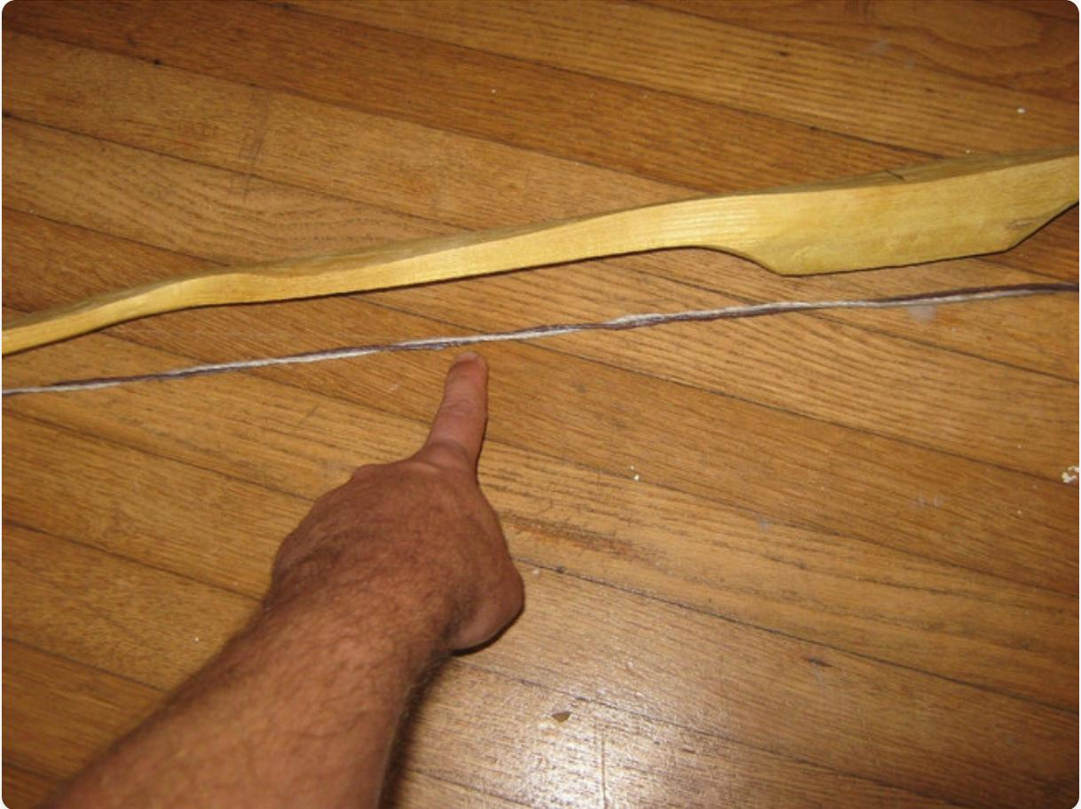
将环套入上弓槽，将松松包裹的弦拉紧到握柄。大约在我手指所在的位置，这是你将引入20英寸股线的地方。
