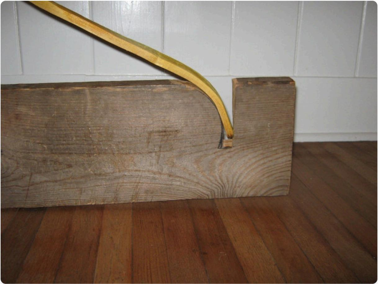
当弯曲浅弯曲时，我仍然使用我的反曲夹具，但只弯曲到我想要的程度。注意夹具的简单性。
