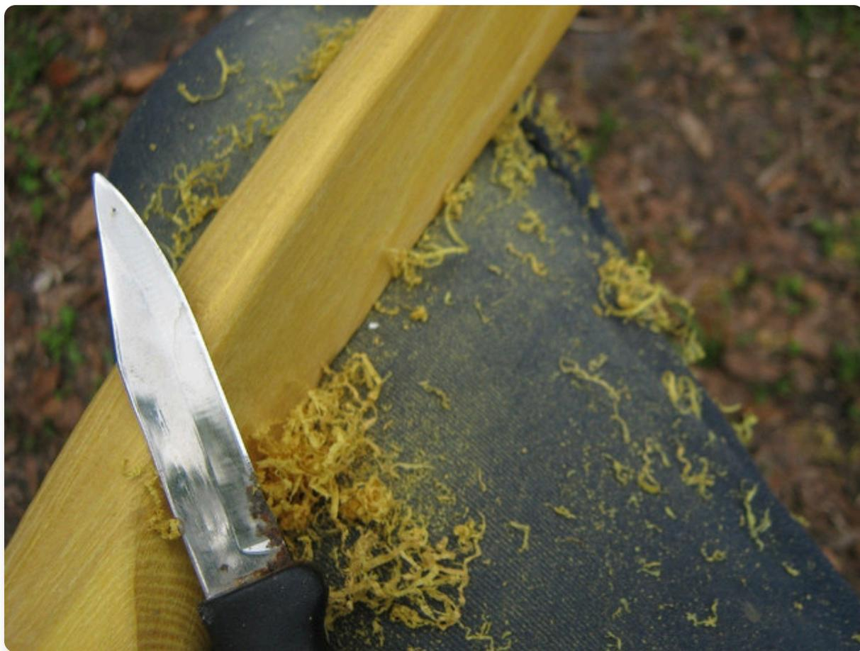
锋利的削皮刀用作刮刀是我发现的最有效的方式，可以快速平滑工具痕迹而不破坏纹理。然后用100目砂纸打磨。
